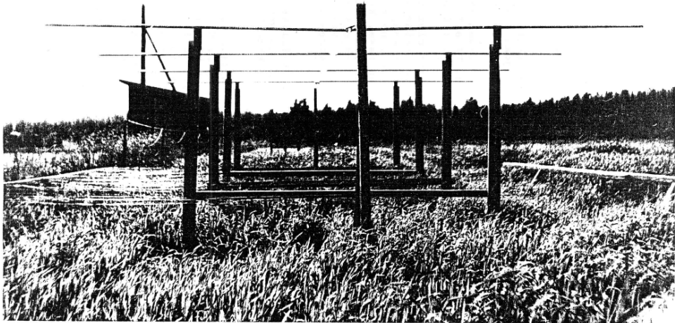
K. 36. "Jätepuuantenni". Toinen kahdesta neljän kokoaltodipolin ryhmästä Viikin koetilan alueella. Taustalla "työnjohtajan koppi". (Heinäkuu 1953)
